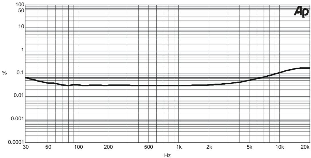
Der Verlauf des Klirrfaktors ist sehr linear und steigt gerade im Tiefbass nur gering an. Die ist nur durch die hochspezialisierten Ausgangstrafos möglich.
