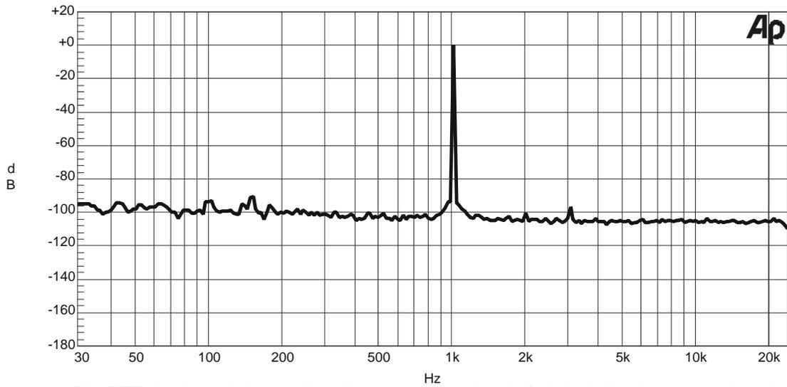
Die FFT-Analyse dokumentiert die extreme spektrale Reinheit des Ausgangssignals. Störungen durch Netzeinflüsse (normalerweise bei 50 und 100 Hz) sind keine vorhanden
