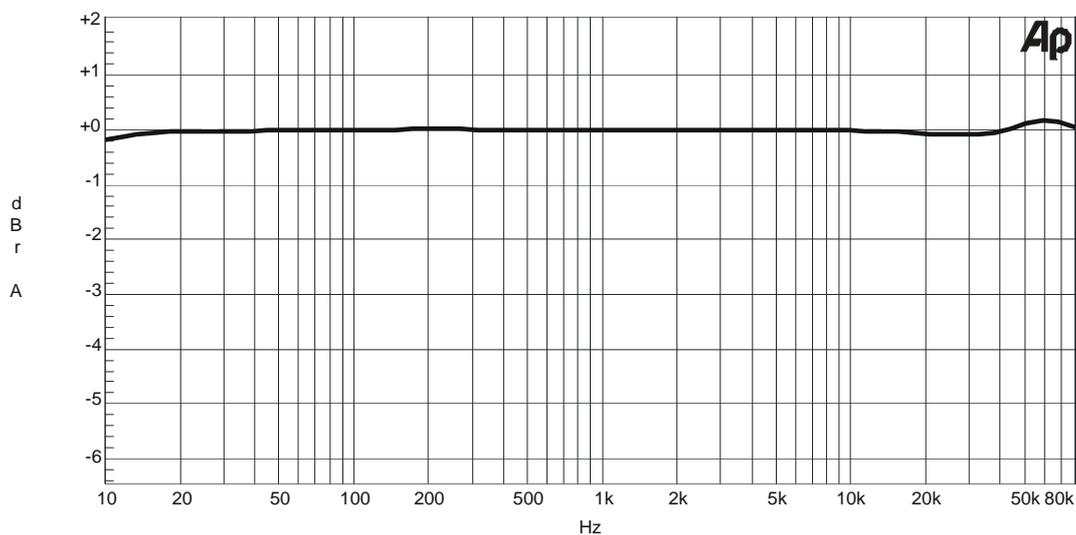
Der Frequenzgang hat innerhalb von 10 Hz bis 90 kHz nur  $\pm 0,3$  dB Toleranz
